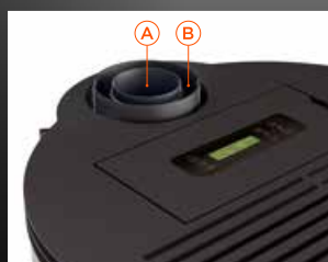
Scarico Coassiale Poujoulat A Uscita fumi B Entrata aria comburente
